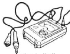
tester izolačního odporu (tester Megger)
